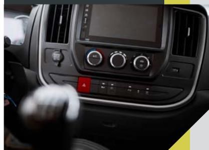
Мультимедиа система с сенсорным монитором и камерой заднего вида.
